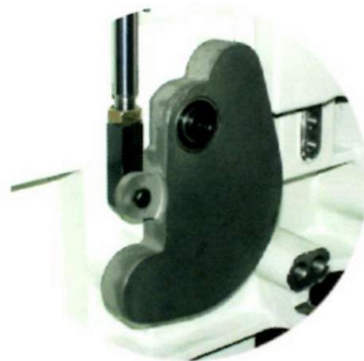
■ 曲線凸輪式倒刀結構 Cam swing mechanism
