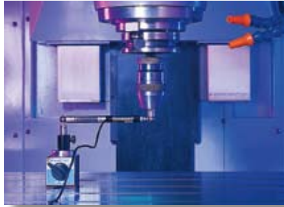
■ BALLBAR TEST 循圓測試
