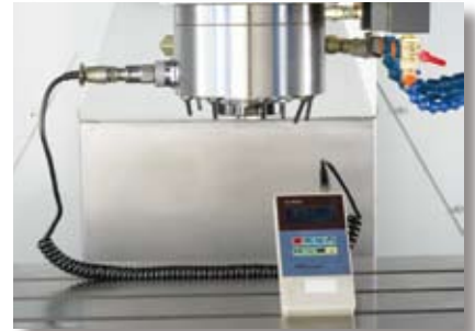
■ SPINDLE VIBRATION TEST 主軸震動測試
